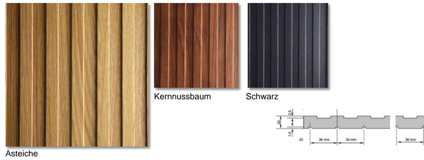
**Bar** ist eine geradlinig verlaufende Struktur in Form eines Stabprofils mit Verprägungen in einem Abstand von 5,0 mm und einer Breite von 5,0 mm. Die Tiefe der Verprägung beträgt 1,8 mm.
