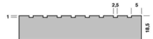
**Light** ist eine geradlinig verlaufende Struktur in Form eines Stabprofils mit Verprägungen in einem Abstand von 2,5 mm und einer Breite von 5,0 mm. Die Tiefe der Verprägung beträgt 1,0 mm.
