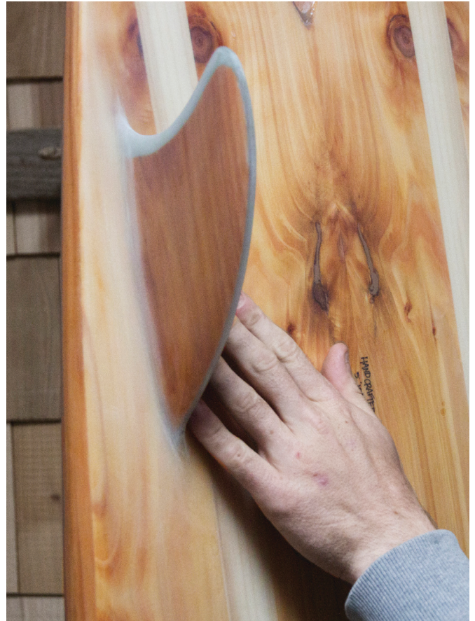
Überprüfung des Holzschliffs vor der Oberflächenversiegelung
