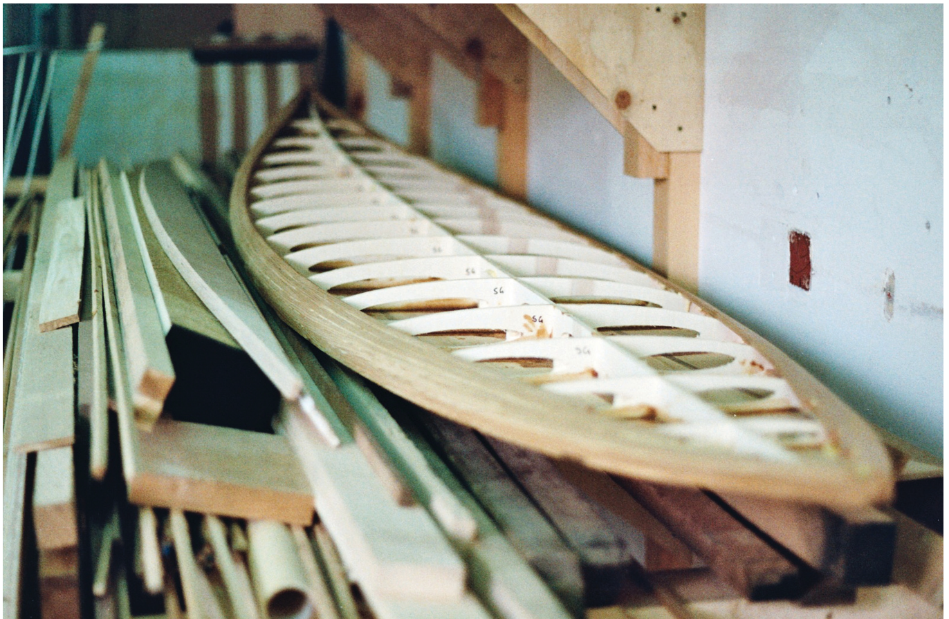
Gerst eines Surfboards aus Stringer, Querrippen und Leisten / Typ: »Cutter« (Material: Zedernholz)
