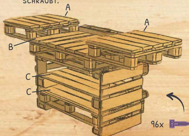
8. ALS LETZTEN SCHRITT LEGEN SIE DIE TERRASSENDIELENZUSCHNITTE AUF, BOHREN DIESE VOR UND VERSCHRAUBEN SIE ANSCHLIESSEND. FERTIG.
