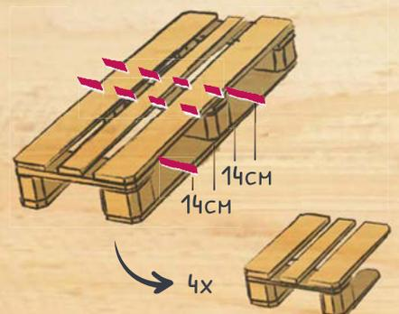
4. FÜR DIE BANKSEITENTEILE ZWEI DER PALETTEN AUS SCHRITT 3 AN DEN SCHNITTKANTEN ZERSÄGEN.
