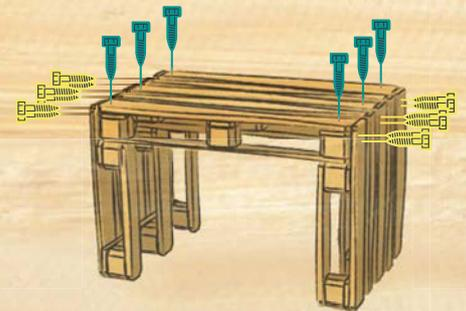
2. DIE SEITENTEILE HOCHKANT STELLEN, EINE PALETTE DAZWISCHEN LEGEN UND ANSCHLIEßEND VERSCHRAUBEN. SCHON IST DER TISCH FERTIG.
