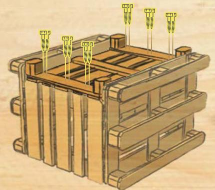
4. DIE PALETTE AUS SCHRITT 3 MIT DEM RÜCKEN AUF DIE SEITENTEILE LEGEN UND VERSCHRAUBEN.
