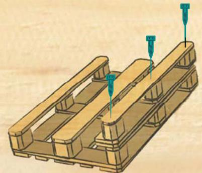
2. DAS KLEINE PALETTENSTÜCK UNTER EINER WEITEREN PALETTE PLATZIEREN UND VERSCHRAUBEN.
