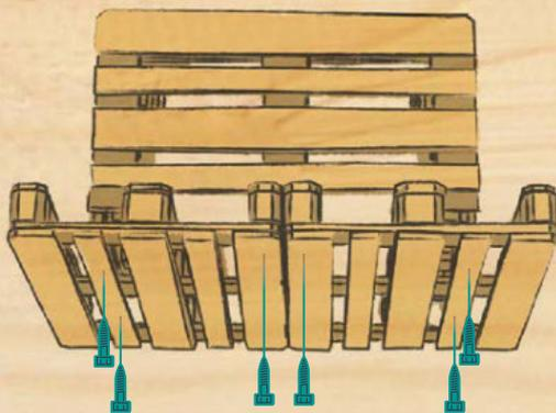
5. DIE BEIDEN VERSCHRAUBTEN PALETTEN HOCHKANT STELLEN, MITTIG VOR DER ABLAGE PLATZIEREN UND ANSCHLIESSEND FESTSCHRAUBEN.
