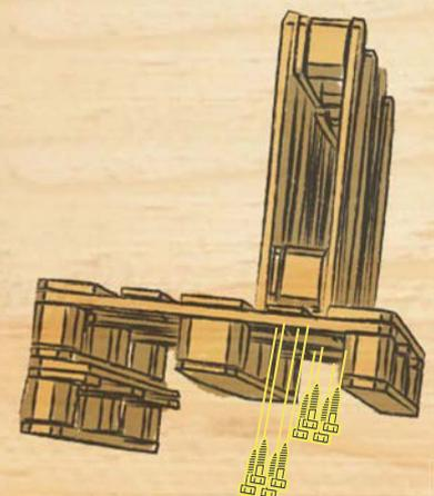
4. DIE BEIDEN RÜCKENTEILE IN DIE PALETTE STECKEN UND VON UNTEN MIT JE 4 SCHRAUBEN FESTSCHRAUBEN.
