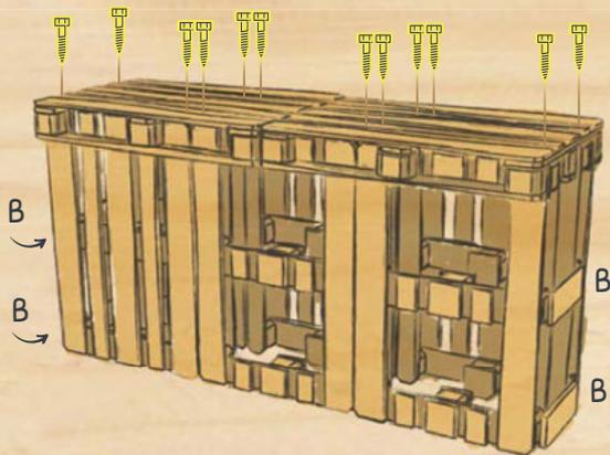
7. ZUR STABILISIERUNG SCHRAUBEN SIE DIE VIER BRETTER B AUS SCHRITT 1 AN BEIDE SEITEN. JETZT KÖNNEN SIE AUCH DIE BEIDEN OBEREN PALETTEN FESTSCHRAUBEN.
