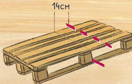
1. FÜR DIE TISCHSEITENTEILE ZWEI PALETTEN AN DEN SCHNITTKANTEN 2x ABSÄGEN!
