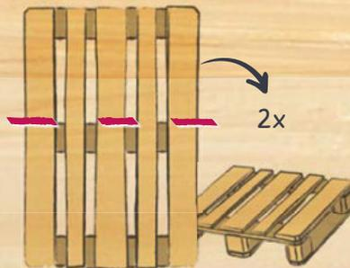
1. FÜR DIE SEITENTEILE ZWEI PALETTEN AN DER ROTEN MARKIERUNG ZERSÄGEN.
