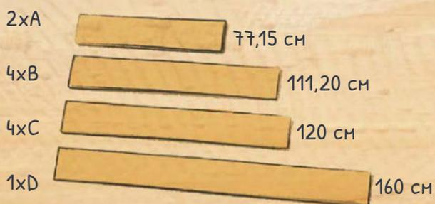
7. ZUR VERKLEIDUNG DER BAR SÄGEN SIE DIE TERRASSENDIELEN IN DIE AUFGEFÜHRTEN LÄNGEN.
