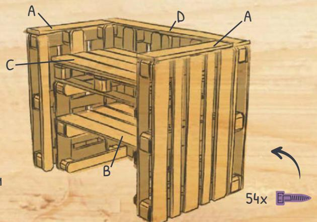
8. ALS LETZTEN SCHRITT LEGEN SIE DIE TERRASSENDIELENZUSCHNITTE AUF, BOHREN DIESE VOR UND VERSCHRAUBEN SIE ANSCHLIESSEND. FERTIG.
