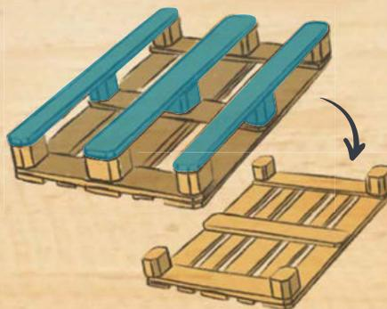
3. DIE BLAUE TEILE ENTFERNEN. ZWEI DER LATTEN WERDEN FÜR SCHRITT 5 BENÖTIGT.
