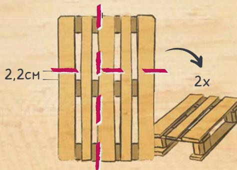
3. EINE PALETTE AN DEN SCHNITTKANTEN ABSÄGEN. EIN WEITERES STÜCK KÖNNEN SIE AUS DEM RESTSTÜCK VON SCHRITT 1 SÄGEN.
