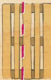
3. FÜR DIE BEIDEN BÄNKE VIER PALETTEN AN DER MARKIERUNG, DIREKT AN DER LATTE, DURCHSÄGEN.
