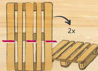
1. FÜR DIE SEITENTEILE ZWEI PALETTEN AN DER ROTEN MARKIERUNG ZERSÄGEN.
