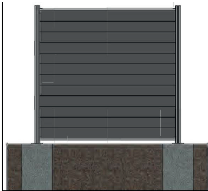
Fertiges Element mit Stellfuß auf Betonfundament
